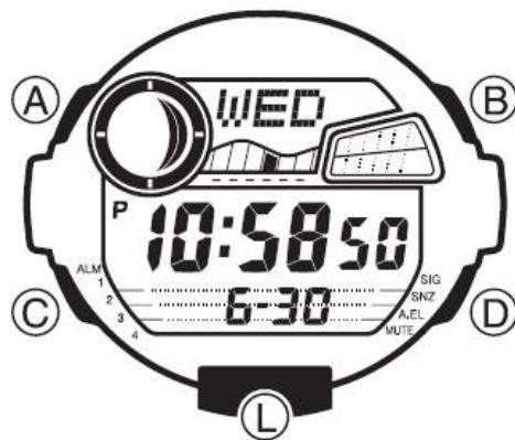
На рисунке изображен общий вид часов в Режиме Текущего Времени. Последовательное нажатие кнопки “C” обеспечивает переход из разряда в разряд в следующей последовательности: Режим Текущего Времени – Режим Лунного Времени – Режим Первого Секундомера – Режим Второго Секундомера – Режим Таймера Обратного Отсчета – Режим Звукового Сигнала – Режим Мирового Времени – Режим Текущего Времени.
