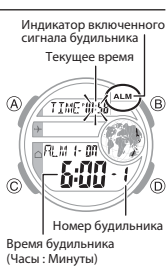
Индикатор включенного сигнала будильника Текущее время Номер будильника Время будильника (Часы : Минуты)
